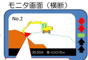
①マシンガイダンスを用い、法丁張りの代わりに、法面の切り出し位置と法面勾配の見本となる程度の法面を作成
